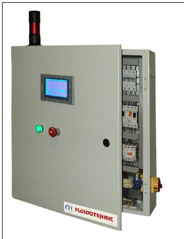
U serijskoj proizvodnji postoje upravlja ke jedinice za dvolinijske, progresivne, jednolinijske i višelinjske sisteme za centralno podmazivanje. Ove elektro jedinice vrše upravljanje i kontrolu rada sistema centralnog podmazivanja. Rukovanje sistemom za podmazivanje mogu e je u ru nom i automatskom režimu. Regularni režim rada je automatski, ru ni režim se bira za potrebe podešavanja servisnih radnji.
